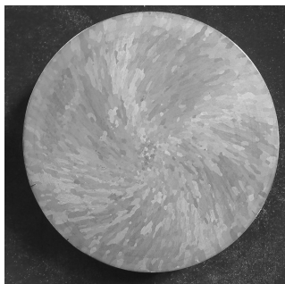
图 9 磁搅拌铸锭横截面宏观组织
