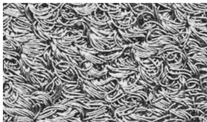
图 1 金属橡胶材料内部组织
