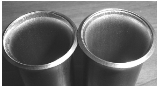
图 4 \Phi 19.05 \text{ mm} \times 1.244 \text{ mm} Gr.2 纯钛管扩口照片
