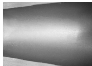
图 2 Φ27 mm×3.1 mm, 3.0 mm Gr.2 纯钛管内表面照片
