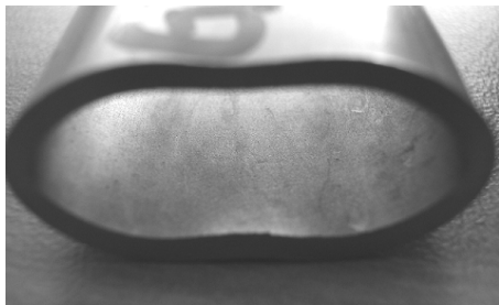
图 5 \Phi 19.05 \text{ mm} \times 1.244 \text{ mm} Gr.2 纯钛管压扁照片
