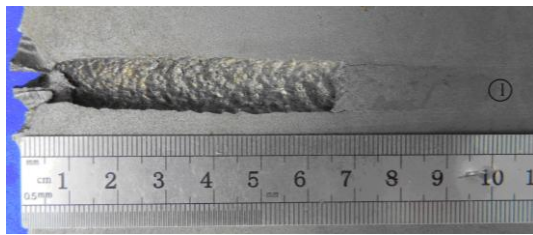
图 6 4#弹(93 钨合金)孔的线切割剖面照片
