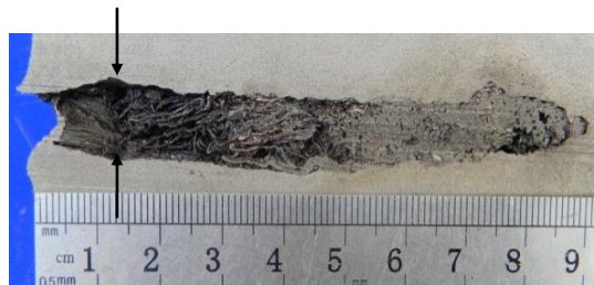
图 3 3#弹(复合材料)孔的线切割剖面照片 Fig.3 Picture of cross-section of 3# (composite, v=1507.5 m/s)
