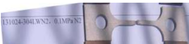
图 2 空白样品氮气惰性气氛下宏观断口形貌
