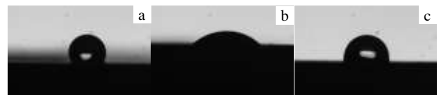
图 7 不同液滴在水热5 d膜层表面的接触形态
