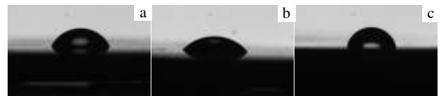
图 6 不同液滴在TA2表面的接触形态
