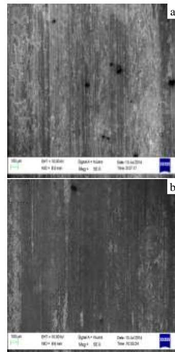
图 7 高熵合金涂层磨损后的表面形貌
