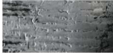
图 3 铸造速度为 30 mm/min 时板坯表面冷隔
