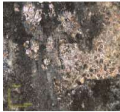
图 4 氧化膜层微动磨损区域局部显微照片
