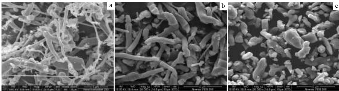
图 1 不同热处理温度下 SiC w 的 SEM 照片
