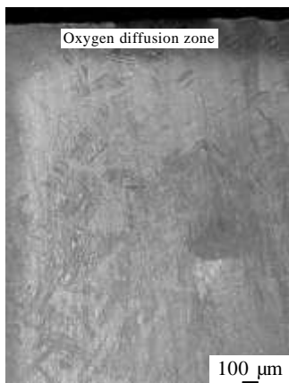
图 7 经真空扩散的氧化涂层的剖面形貌
