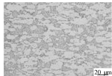
图 2 TC4 钛合金母材显微组织
