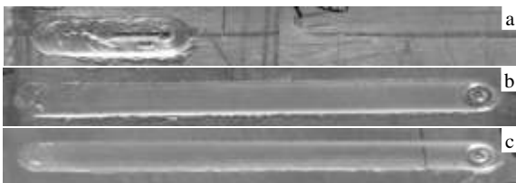
图 2 不同焊接工艺参数下焊缝表面成形
