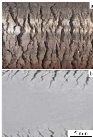
图 5 制品表面裂纹形貌
