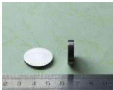
图 2 Fe 基非晶复合材料烧结试样
