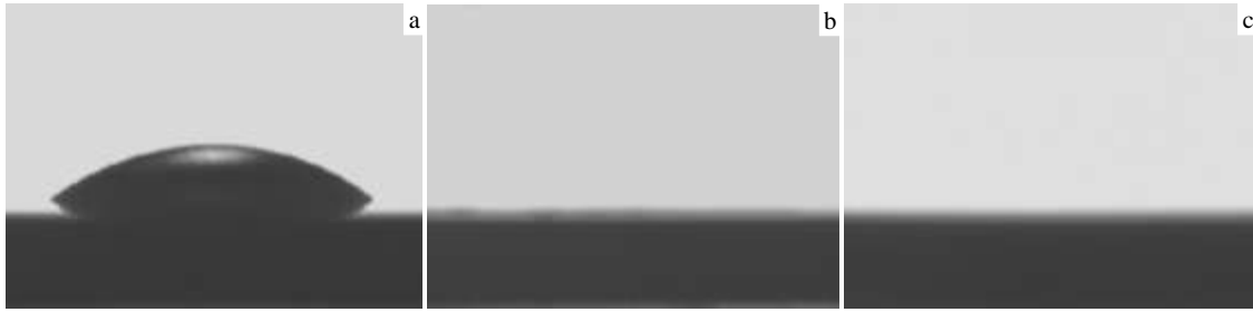
图 2 水滴与不同试样表面的接触角
