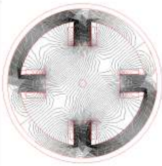
图 6 电磁搅拌器磁场分布 Fig.6 Magnetic field of EMS
