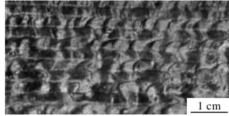
图 1 激光熔覆磷酸钙陶瓷涂层的表面宏观形貌
