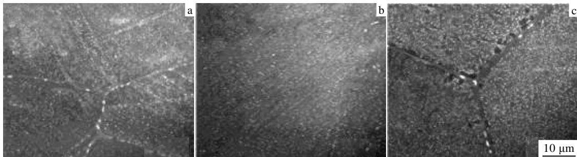
图 3 Mg-3Sn、Mg-6Sn、Mg-10Sn 合金在 250 °C 时效 24 h 后的 SEM 组织 Fig.3 SEM images of the alloys aged at 250 °C for 24 h: (a) Mg-3Sn, (b) Mg-6Sn, and (c) Mg-10Sn
