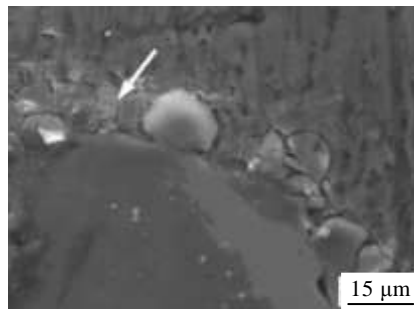
图 4 界面处钝化膜破裂形貌
