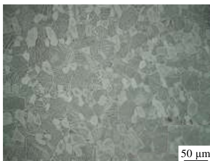
图 2 Ti-6Al-4V 微观双态组织结构
