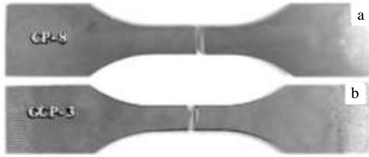
图 2 TA15 合金试样断裂后宏观形貌
