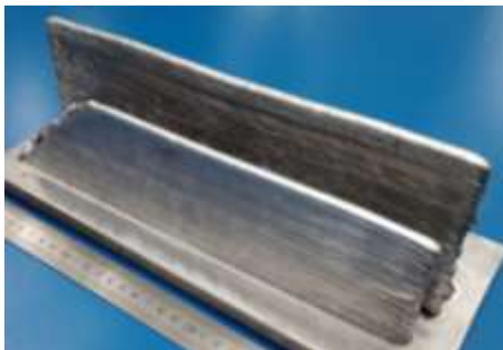
图 1 D-WAAM Al-Cu-Mg 合金试件
