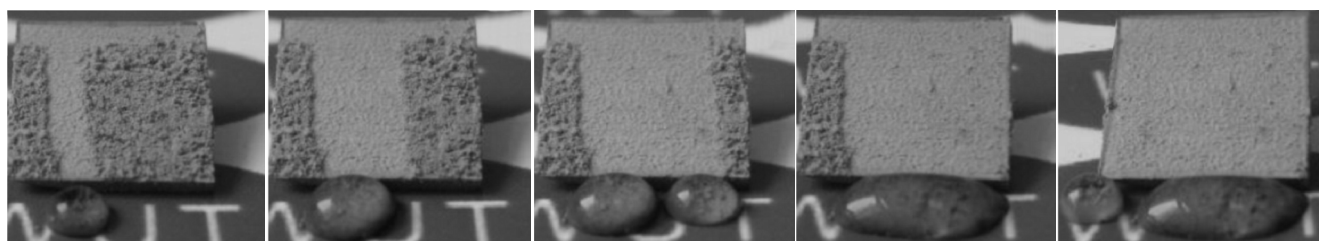
图9 超疏水样品 H 表面的自清洁实验图
