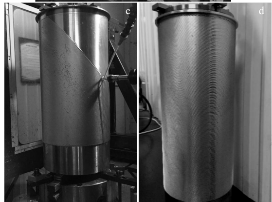
图 14 采用数控机床加工一段铝合金骨架
