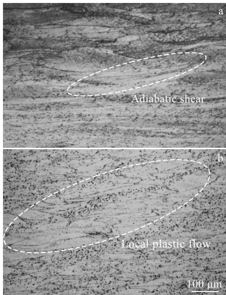
图 8 Ti-22Al-24Nb 合金失稳区的微观组织
