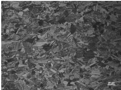
图 1 TiAl 合金显微组织照片
