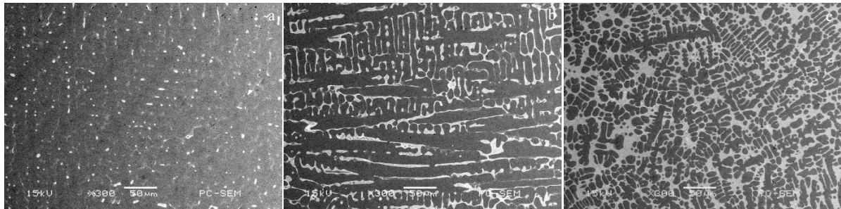
图 2 氩弧熔炼合金铸锭 SEM-BSE 像
