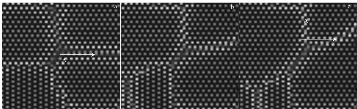
图 3 \text{Ni}_{75}\text{Al}_{3.5}\text{V}_{21.5} 合金在 1100 K 下沉淀过程的组织演化图
