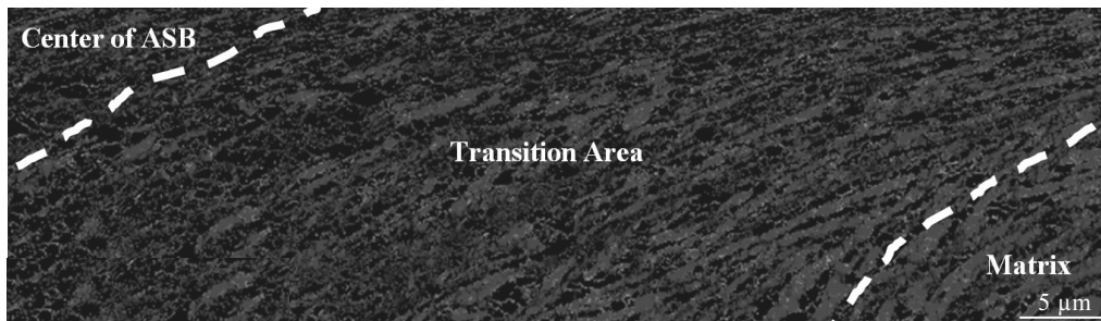
图 5 魏氏组织 TC17 钛合金在 700 °C, 40%变形的 ASB 过渡区 EBSD 相分布图
