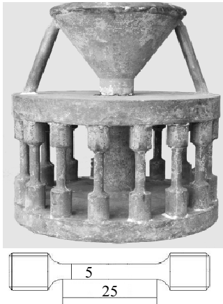
图 1 铸造试样形状及试棒尺寸
