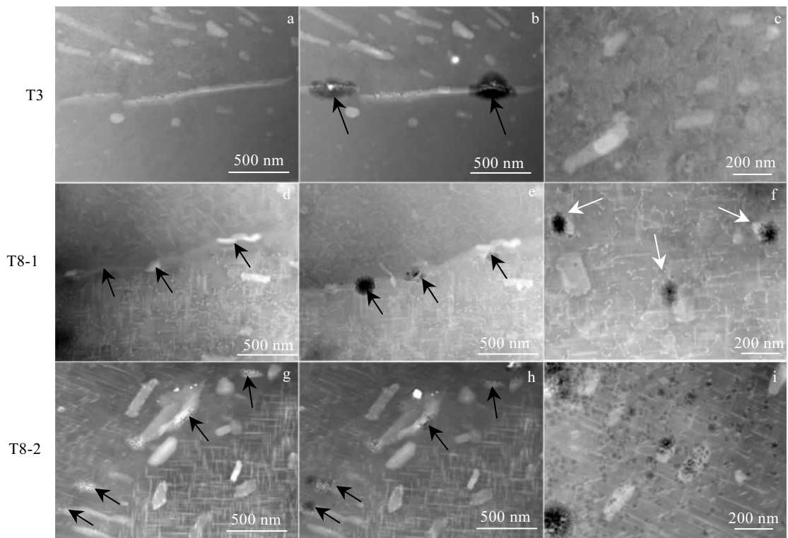
图 6 不同热处理状态的 AA2024 铝合金晶界准原位腐蚀和晶内腐蚀的 HAADF-STEM 图像
