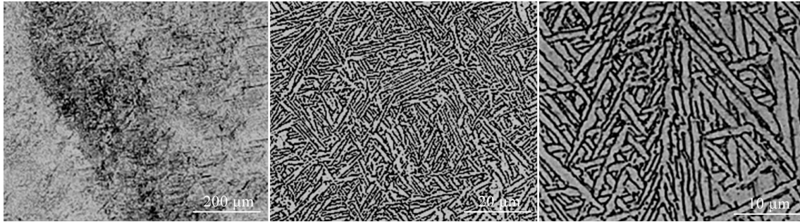
图 2 TC4 合金激光沉积制造沉积态显微组织
