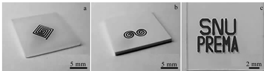
图 2 PE、ABS 和钙钠玻璃材料上制备的金属铜图案
