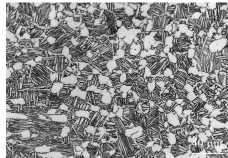
图 1 试验用双态组织 Ti80 合金
