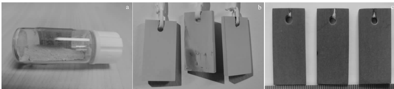
图 1 CP-Ti 表面附着物宏观形貌
