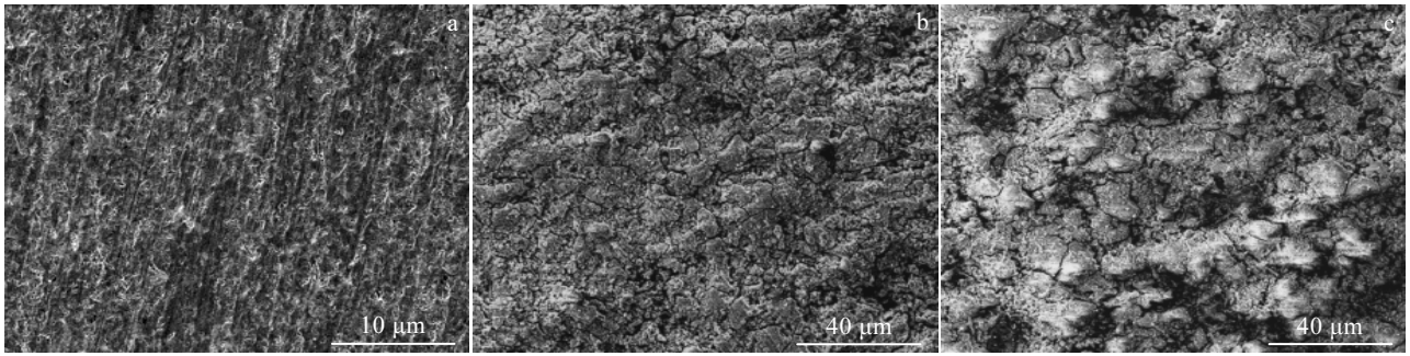
图 7 不同 Ga 含量合金在 70 °C 纯水中降解 1 min 后的腐蚀形貌
