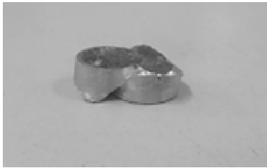
图 3 变形态镁合金在 473 K 下热压缩出现剪切断裂
