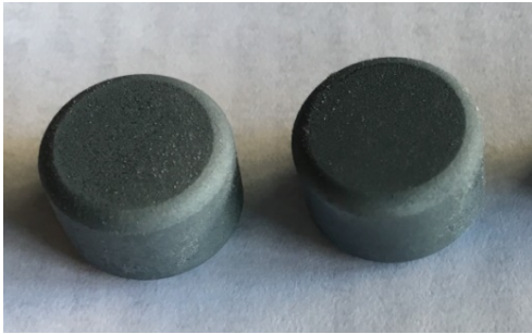
图 5 带抗氧化涂层的钼钨合金样品
