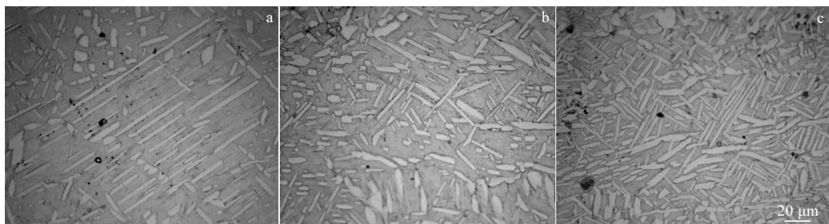
图 7 三道次变形 (1050 °C→950 °C) 试样时效处理后的显微组织
