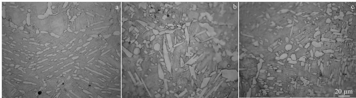
图9 三道次变形(950℃→850℃)试样时效处理后的显微组织
