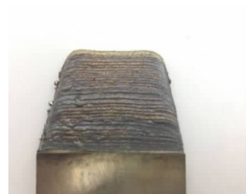
图 2 激光沉积修复 DZ125 修复件
