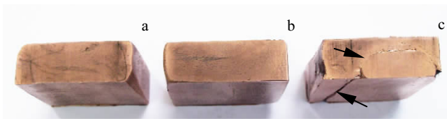
图 6 高宽比为 3 的试样不同道次镦压后的形状
