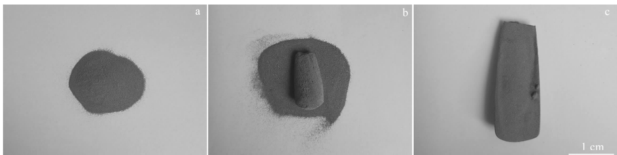
图7 Ti-Ni预合金粉末在不同热处理温度下的烧结状态
