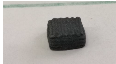
图 3 打印成型的梯度结构阳极块
