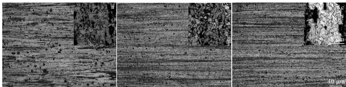
图 5 铸态 Mg-6Al-2Ca-2Sm 合金及其分别在固溶和固溶+时效后的热挤压纵向金相照片
