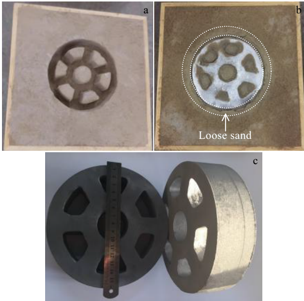
图 7 冷冻砂型浇注过程
