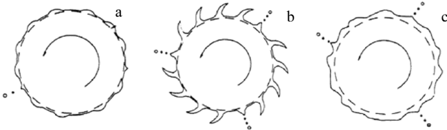
图 3 雾化盘边缘 3 种分裂模式
