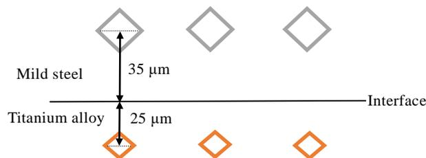
图 1 界面附近的硬度测试点示意图
