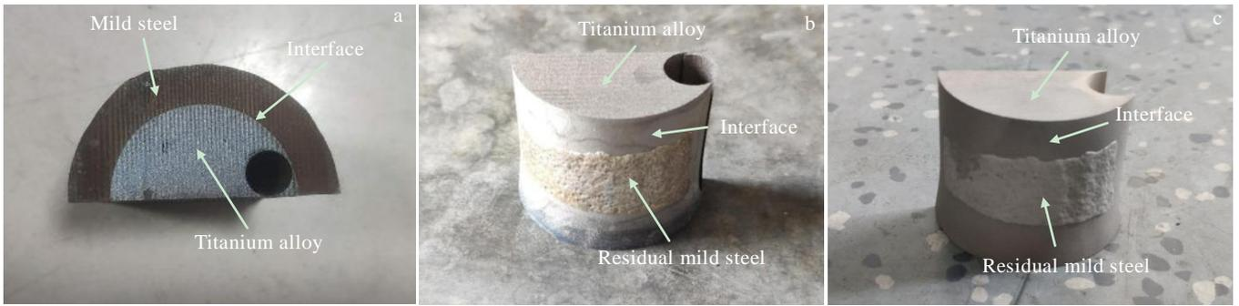
图 2 热等静压原始态，选择性化学洗，选择性化学洗+喷砂 3 种状态的热等静压压坯宏观形貌
