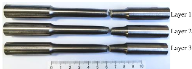
图 12 接头各层的拉伸断裂位置
