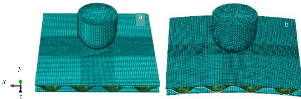
图 2 平面蛋盒型夹芯板及曲面蛋盒型夹芯板落锤冲击模型
